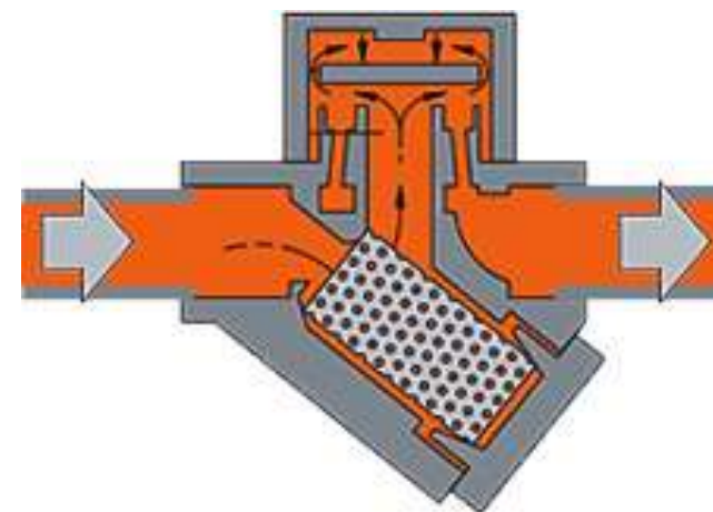
ディスク式トラップ断面図
