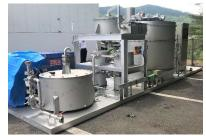
原料自体を燃やさず、酸素も使わないこの装置は、全ての有機物ゴミが油化・炭化処理で 有効利用でき、常圧の加熱水蒸気による加熱分解処理が出来ます。
