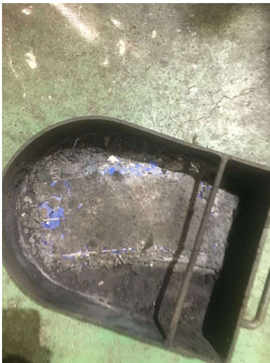
3. 熱分解中に出た蒸気を水に落とした写真
