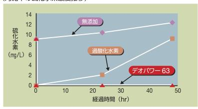
薬品無添加の場合は硫化水素が高濃度(9~12ppm)のままです。過酸化水素を添加しますと硫化水素濃度は低濃度で20時間程度は維持できますが、再び濃度が上昇し50時間後には8ppmに達して悪臭を放ちます。デオパワーを使用しますと、50時間経過してもまったく臭気の発生はなく消臭効果が持続します。
